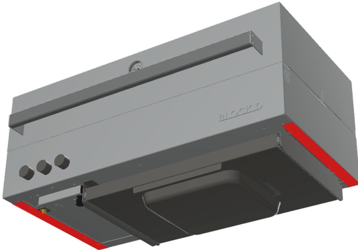
Nutzen Sie die rot markierten Flächen, zum Abstellen und fixieren des Grills auf einer Unterkonstruktion. Die Flächen haben eine Breite von max. 50mm links und max. 35mm rechts.
