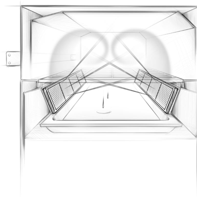
Die Brenner der Flammkraft-Grills sind so angeordnet, dass heruntertropfende Flüssigkeiten direkt in einer Tropfschale aufgefangen werden. Dies hilft ungesunde Rauchbildung zu vermeiden und sorgt für ein entspanntes Grillerlebnis.
