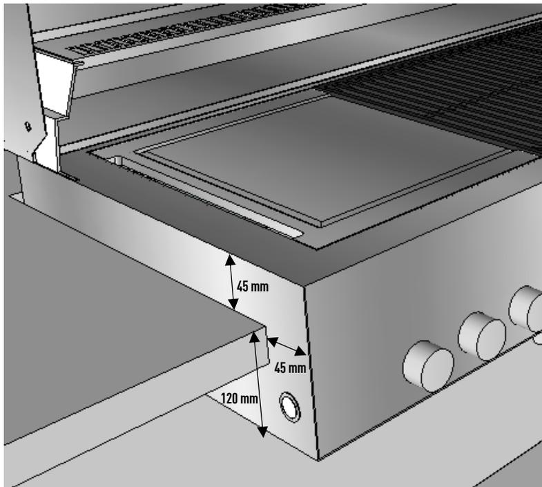
Der Grill muss ca. 45 mm nach oben aus der Arbeitsfläche herausstehen. Andernfalls werden auf der Rückseite Lüftungsschlitze verdeckt und die Nutzung der Rotisserie ist nicht möglich.
