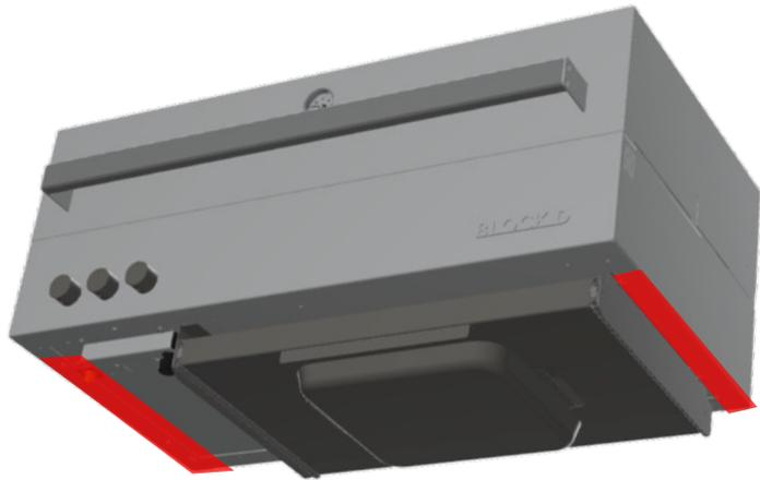
Nutzen Sie die rot markierten Flächen, zum Abstellen und fixieren des Grills auf einer Unterkonstruktion. Die Flächen haben eine Breite von max. 50 mm links und max. 35 mm rechts.
