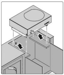
Setzen Sie das Gerät auf die Unterkonstruktion.
